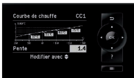
Régulation Vitotronic – facilité d'utilisation grâce au guidage par menus et à l'affichage graphique, par exemple des courbes de chauffe
