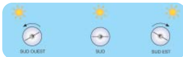
Tube pivotant pouvant être ajusté pour récupérer une orientation plein sud
