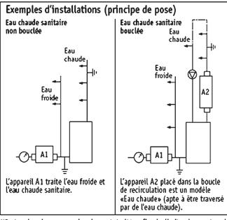
NB. Les bouclages eau chaude sont traités afin de limiter les pertes de traitement dues aux dégazages de CO<sub>2</sub> qui se produisent dans les bouclages.
