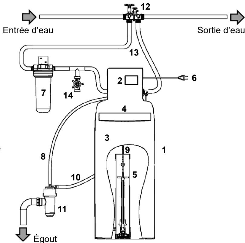
Il incombe à l'installateur de s'assurer que l'installation n'engendre pas de coups de béliers pouvant nuire au bon fonctionnement de l'appareil. Il est fortement recommandé de raccorder l'appareil avec des flexibles.
